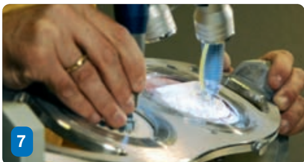
7 • Se trabaja con la encimera inclinada (individualmente ajustable) para fresar por ejem. los cortes inferiores.
