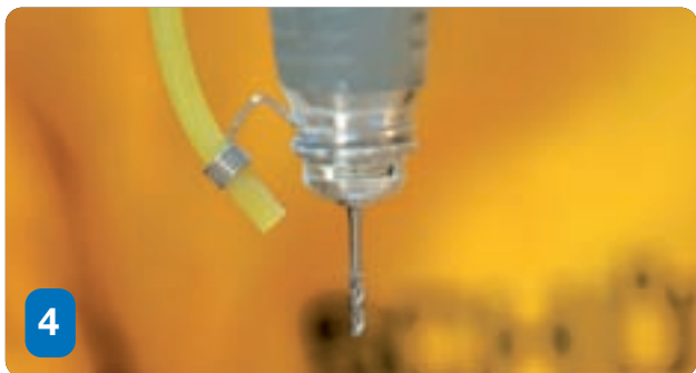
4 • Se cambia a una fresadora más fina (aquí fresadora 2).
