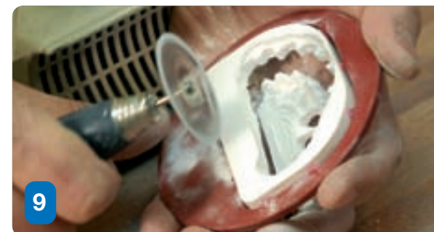
9 • Se quita la pieza por completo mediante un disco de afilamiento.
