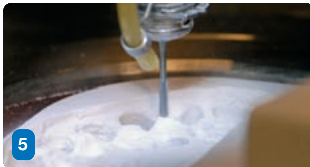
5 • La elaboración de los detalles de la modelación en ambos lados, se cambia a la siguiente fresadora más fina (aquí fresadora 1).
